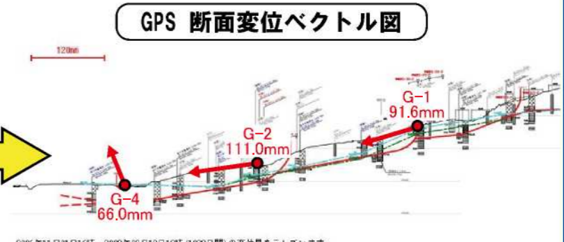
2006年11月01日16時～2009年08月18日19時(1022日間)の変位量を示しています。
