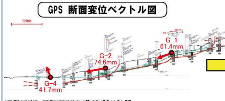
2006年11月01日16時～2009年08月18日16時(656日間)の変位量を示しています。
